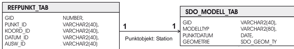
Abbildung 2.8: Aufbau des Untermoduls Punktobjekt unter Verwendung des Spatial-Data-Objektes und des Datentyps DATE zur Festlegung der Stationskoordinaten.
