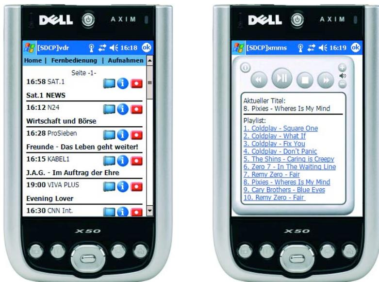
Bild links: Mittels SDCP wird aus einem PDA eine Fernbedienung für einen digitalen Videorekorder. Bild rechts: Rückmeldungen des bedienten Gerätes erlauben die Anzeige des aktuellen Status (hier der gespielte Titel)
