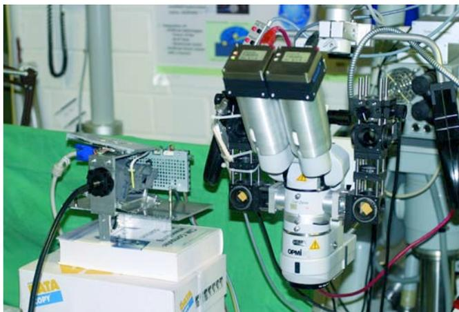
Neues, leistungsstarkes Einblendmodul auf DLP-Basis (links) und Kameraadapter zur automatischen Kalibration mit Hilfe von Firewire-Kameras
