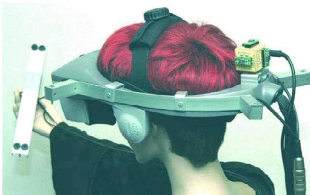
*Stereo-Head-Mounted-Display, welches mit Mikrofonen und einem Gyroskopwürfel ausgestattet wurde, sowie einem Handtracker, bestehend aus 4 Mikrofonen.*
