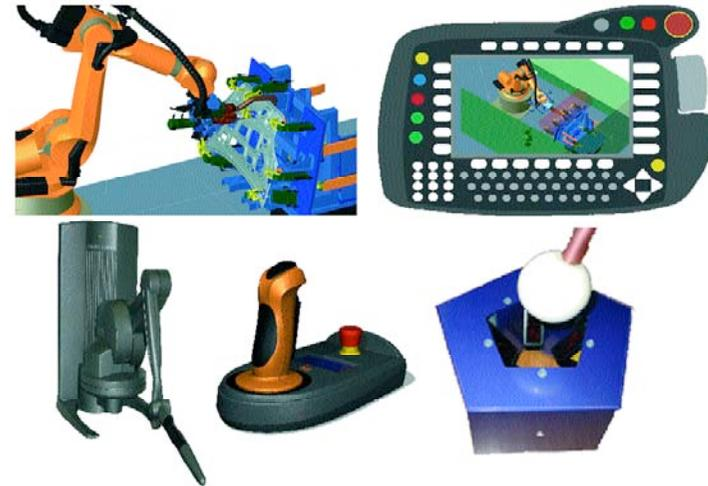
*Kernkomponente von IroProg: oben links: Roboter-Simulationssystem; oben rechts: Zellenmodell auf der Steuerung; unten links, mitte: intuitive Eingabegeräte; unten rechts: Kalibriersystem*
