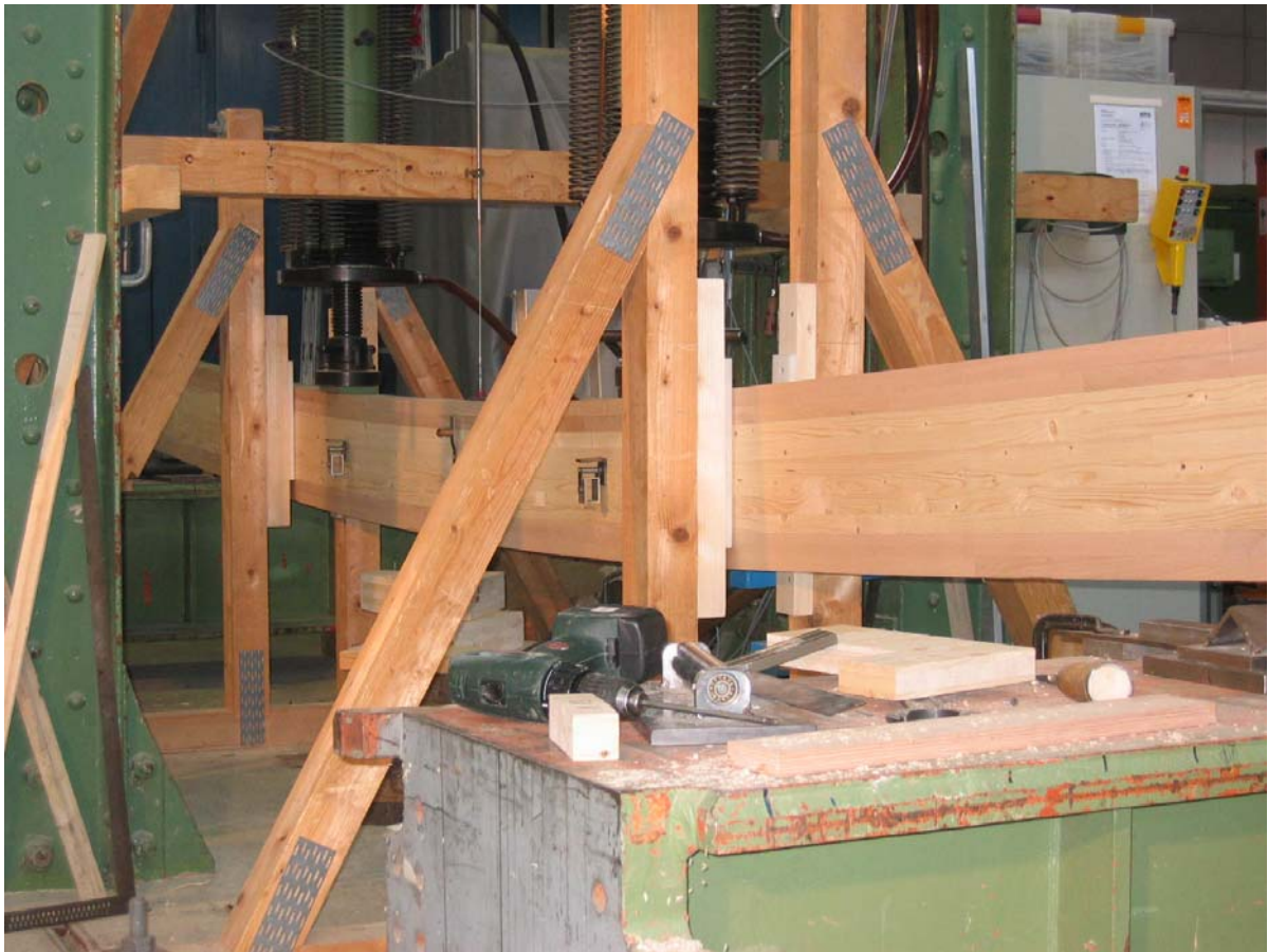
Bild A-4 Träger Nr. 7 während des Biegeversuchs nach EN 408 mit Kippaussteifung
