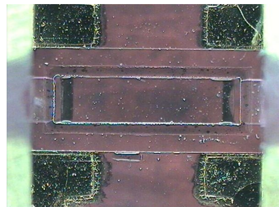
Abb. 6.16: Kleber auf dem erhöhten Rahmen um den Fluidkanal. Zu sehen sind die schwarzen Farbpartikel des Klebers 302-3M BLACK.
