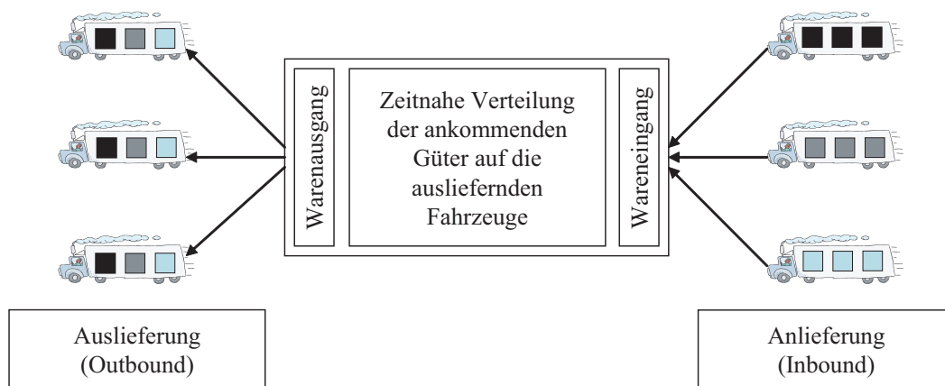
Abbildung 2.1: Das Crossdocking-Konzept: Die ankommenden Güter (Inbound) werden am bestandslosen Umschlagpunkt auf die Fahrzeuge der Auslieferungstouren (Outbound) verteilt.
