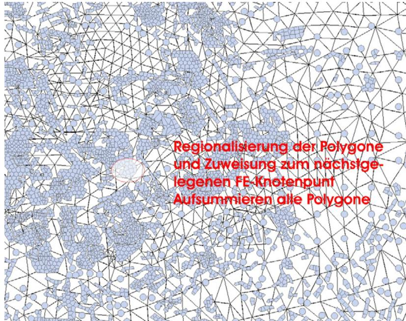
Abbildung 47: Implementierung der in Polygonen vorgegebenen Frachten in das Finite Elemente-Netz. Die flächenhaften Werte werden Knotenpunkten zugewiesen. Alle Polygonwerte, die einem bestimmten Knotenpunkt am nächsten liegen, werden addiert und dem Punkt zugewiesen.
