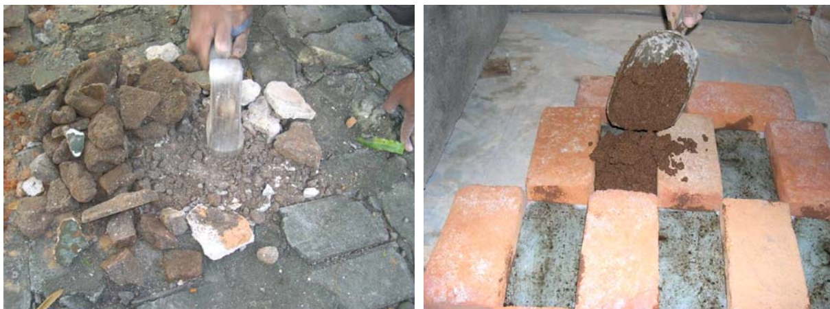
Bild 5-11 Recycling von Bauschutt zur Herstellung von Mauerziegeln
