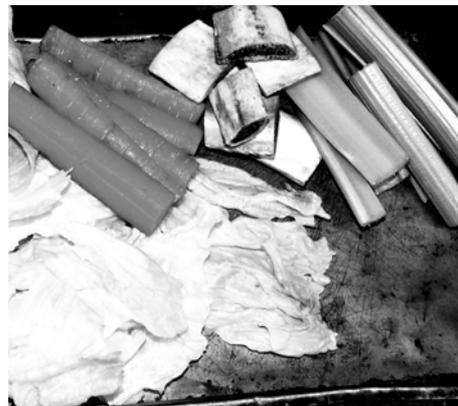
Bild C 4. Links, durchgezogene Linien: Ergebnisse von 11 Nassanalysen nach AHAM *Problematic food grinding test* mit Standardabfall – Links, gestrichelte Linie: Analyse mit Apfelschalenabfall – Rechts: Standardabfall aus gleichen Teilen gekochten Rinderrippenknochen, Möhren, Salat und Sellerie
