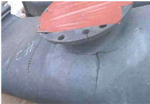
Abb. 1.1-1: Durch Verbrennungsschwingungen initiiertes Riss am Überleitungsstück einer Gasturbine [Vi16].
