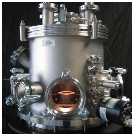
Abbildung 33: Unterdruckbrennkammer des im DLR durchgeführten Experiments. Der Unterdruck bewirkt eine Vergrößerung der Dicke der Flammenstruktur und die Druckabsenkung ermöglicht eine Anpassung der Zeitskalen für Chemie und Diffusion.
