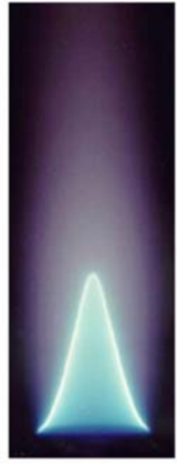
Abbildung 5: Chemolumineszenz (I. Braun) einer laminaren Bunsenflamme. Die Flamme zeigt einen glatten Verlauf. Chemische Reaktionen sind auf eine dünne leuchtende Zone beschränkt. Vor und hinter der Reaktionszone ist die Strömung inert.
