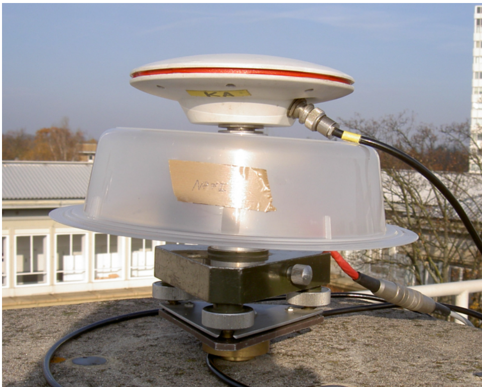
Bild 3-1: GPS-Antenne AT502 auf Drehvorrichtung
