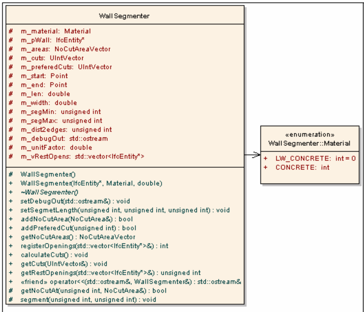
Bild 4.19: Auszug des UML-Diagramms der Klasse „WallSegmenter“ zur Segmentierung
