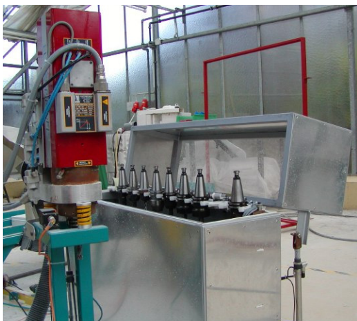
Bild 5.8: Frässpindel und Fräserkasten (links), Seilsäge (rechts)
