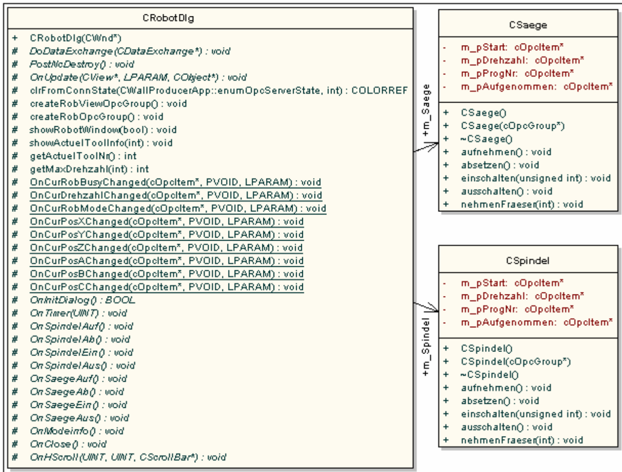
Bild 5.31: UML-Diagramm der Klassen des Roboters
