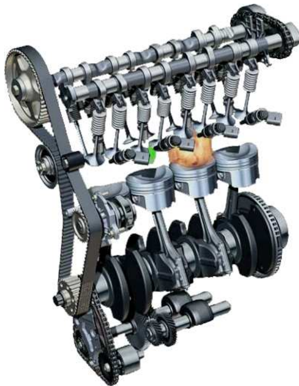
Abbildung 1.1: Zur Reduktion von Ruß und Stickoxiden werden neue Brennverfahren eingesetzt, wie z.B. bei Verbrennungsmotoren die Benzindirekteinspritzung von Kraftstoff (grün gekennzeichnet). Quelle: Audi
