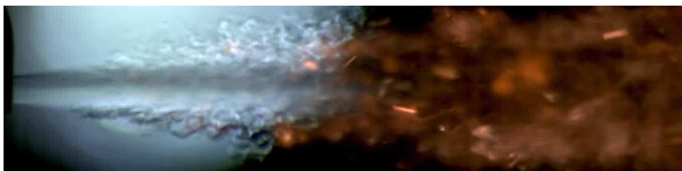
Abbildung 5.3: Verbrennung von DME im zweiphasigen Freistrahls durch Expansion von 87\text{ bar} , 360\text{ K} auf Kammerbedingungen von 35\text{ bar} , 723\text{ K} Luft (vgl. Abb. 2.2). Der flüssige und teilverdampfte Strahl ist in der Schattenaufnahme deutlicher sichtbar, im Rußleuchten ist Tropfenabbrand zu erkennen.
