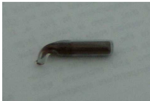
Abbildung 4.1: Beispiel eines eingeschmolzenen Pulvers, hier eine polykristalline \text{CeCu}_6 -Probe
