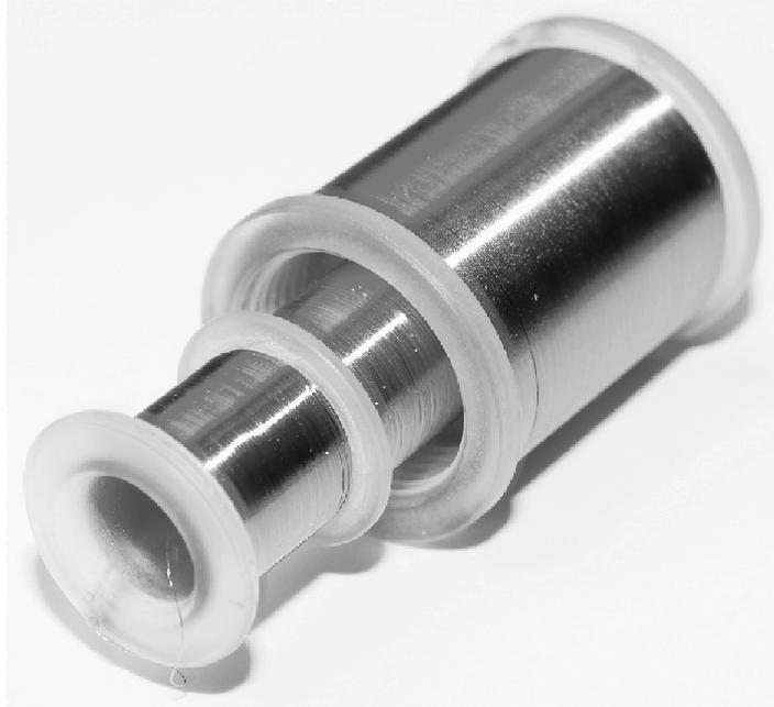
Abb. 5.3: Spule für die Messung der ac-Suszeptibilität. Innere Spule gilt als Pick-Up-Spule, äußere Spule dient als Feld - Spule.
