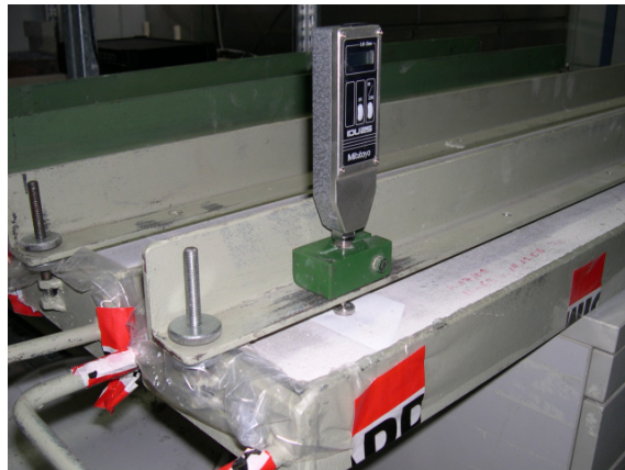
Abb. 11: Verformungsmessung am Schüsselbalken (100 x 15 x 5 cm)
