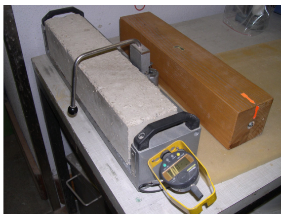
Abb. 12: Verformungsmessung am Schwindbalken (50 x 10 x 10 cm)
