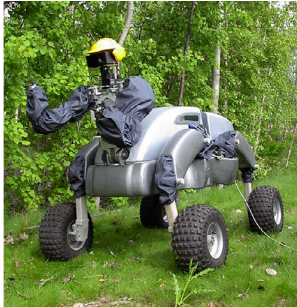
Abbildung 2.7: Der an der Helsinki University of Technology entwickelte mobile zentaurenartige Serviceroboter WORKPARTNER mit hybridem Antriebssystem.
