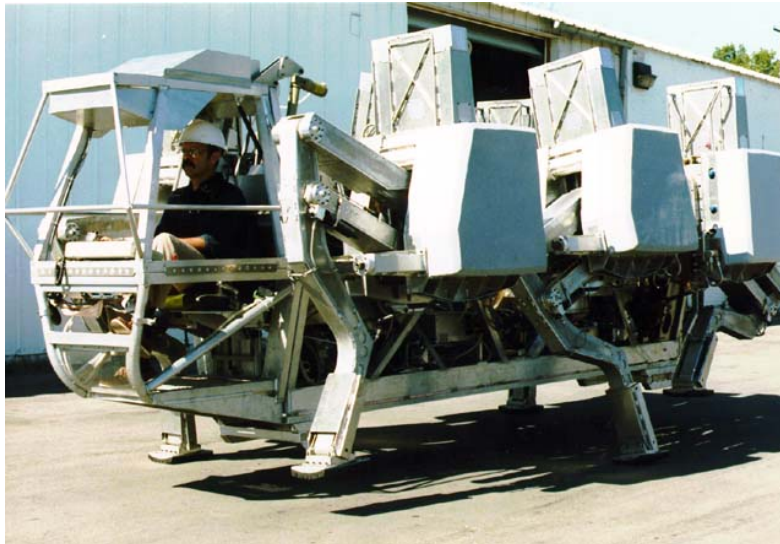
Abbildung 2.1: ADAPTIVE SUSPENSION VEHICLE – Ein experimenteller sechsbeiniger Roboter mit dem Menschen als „Fahrer“.
