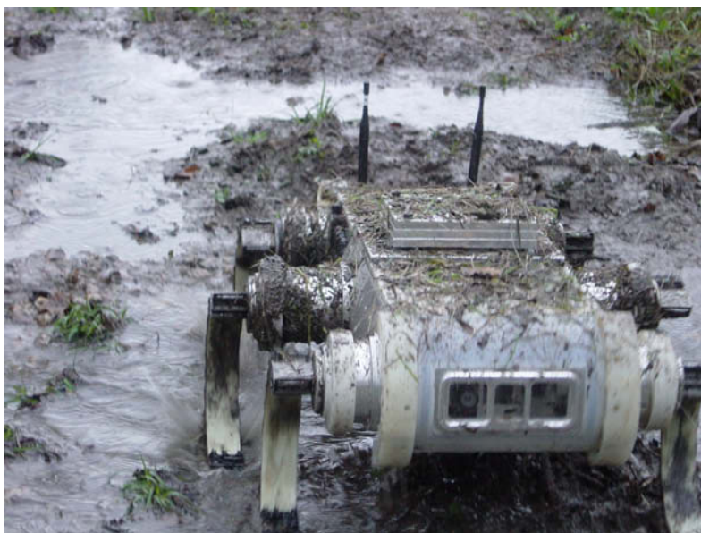
Abbildung 2.5: Die sechsbeinige Laufmaschine RHex mit rotierenden Beinen.
