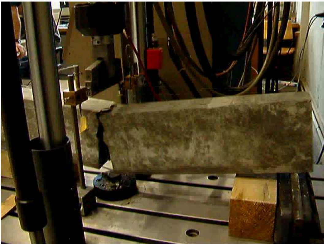
Abbildung 5.7: 3-Punkt-Biegeversuch (Stegemann [132]) kurz nach dem Durchriss
