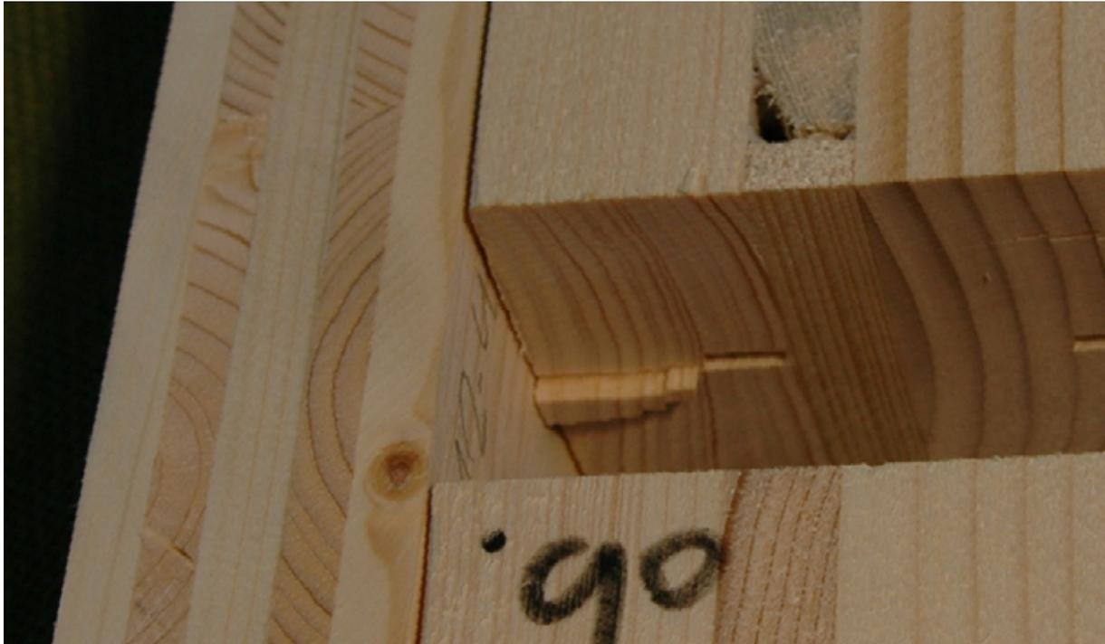
Bild 6-11 Blockscheren in der Decklage des Mittelholzes, hier Versuch mit Stabdübeln, 1-12-42\_1.1.F1
