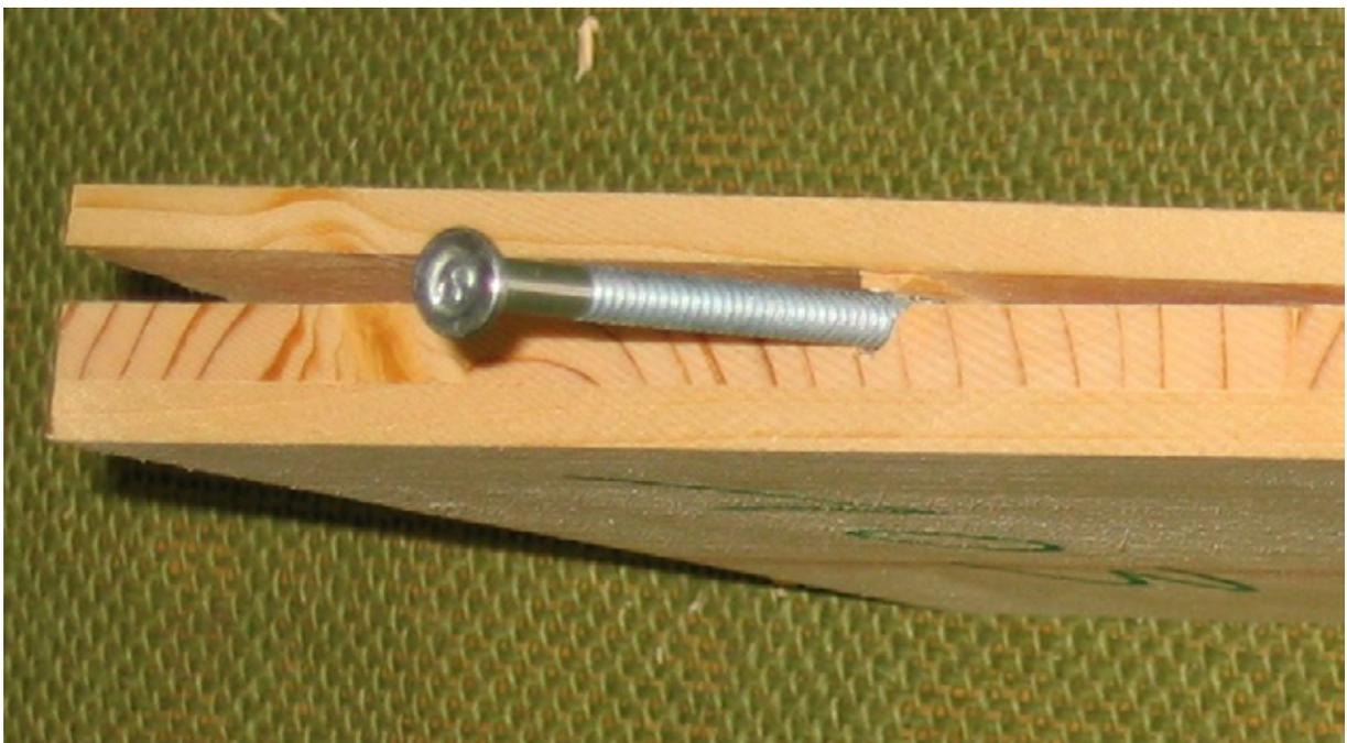
Bild 4-2 Aufspalten von Prüfkörpern beim Einschlagen von Nägeln
