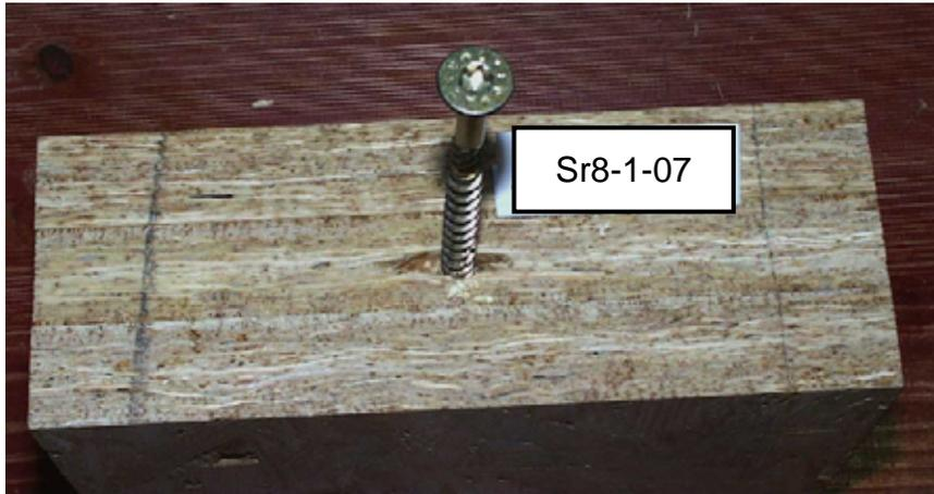
Bild 5-8 Prüfkörper für Versuche zur Ermittlung der Ausziehtragfähigkeit von Schrauben in den Schmalflächen von OSB-Platten
