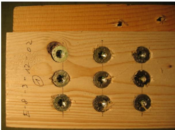
Bild 10-23 Einschraubversuch der Reihe E-8-3-12-2
