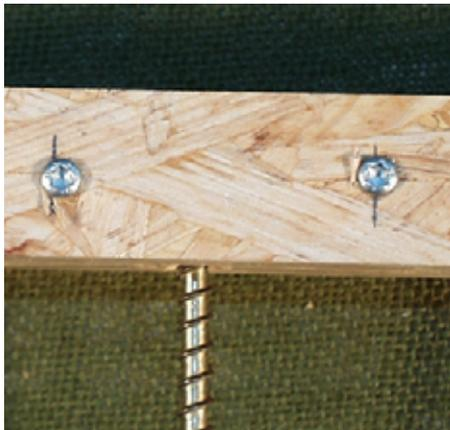
Bild 5-2 Durch Vollgewindeschrauben verstärkter Prüfkörper für Lochleibungsversuche in Schmalflächen von OSB
