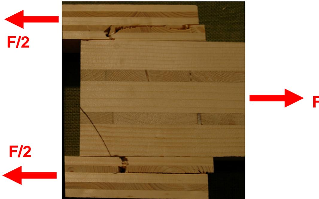
Bild 6-8 Versagen durch Zugversagen und Herausscheren von Brettlagen
