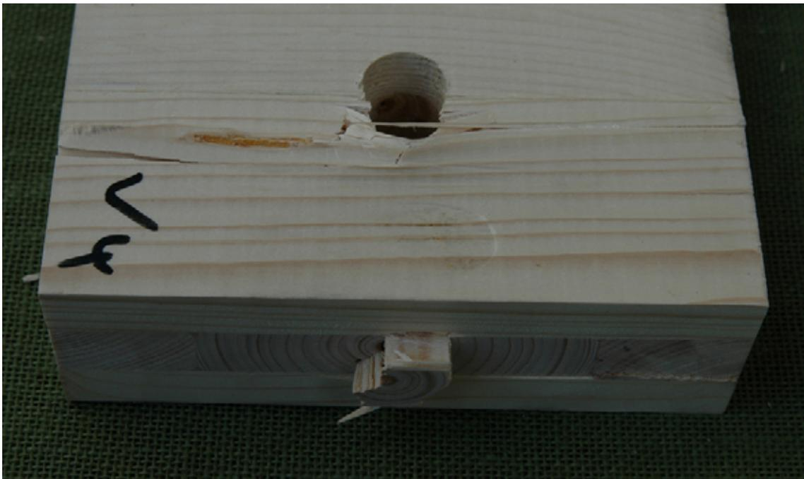
Bild 6-10 Ausscheren eines Blockes in der Mittellage, Versuch 1Q-24-2S\_1.1.1
