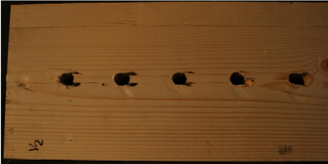
Bild 6-9 Blockscheren in der Decklage zwischen den Stabdübeln und zum Rand, hier Versuch 1-24-2S\_2.1.1
