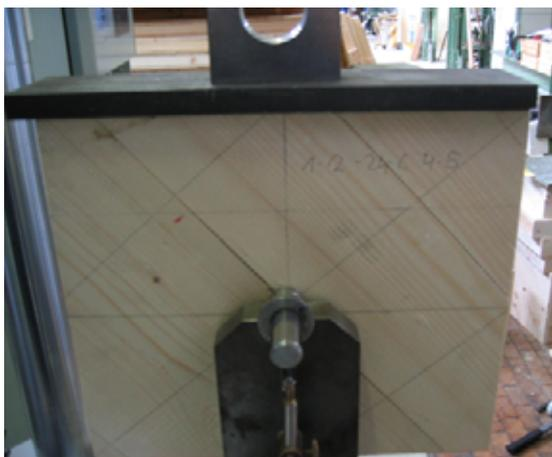
Bild 3-2 Größere Prüfkörperbreite bei Belastung unter  $45^\circ$  zur Decklage
