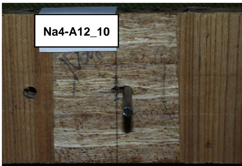
Bild 5-3 Prüfkörper mit Verstärkung durch Furnierstreifen
