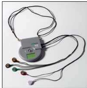
Abbildung 4.2: Automatischer Loop-Event-Rekorder der Firma Vitaphone GmbH. Bei Rhythmusstörungen kann das EKG automatisch über Bluetooth ® an ein Mobiltelefon und von dort aus weiter zur Servicezentrale der Firma übertragen werden.
