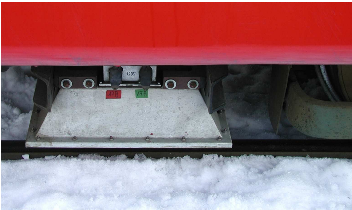
Abbildung 2.5: Der Wirbelstrom-Sensor ist gegenüber Witterungseinflüssen unempfindlich.
