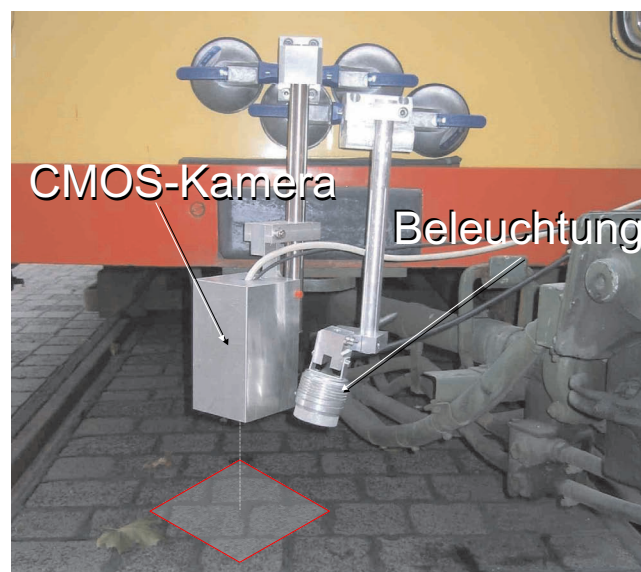
Abbildung 2.1: Optischer Sensor zur berührungslosen Geschwindigkeitsmessung eines Schienenfahrzeugs über Grund.
