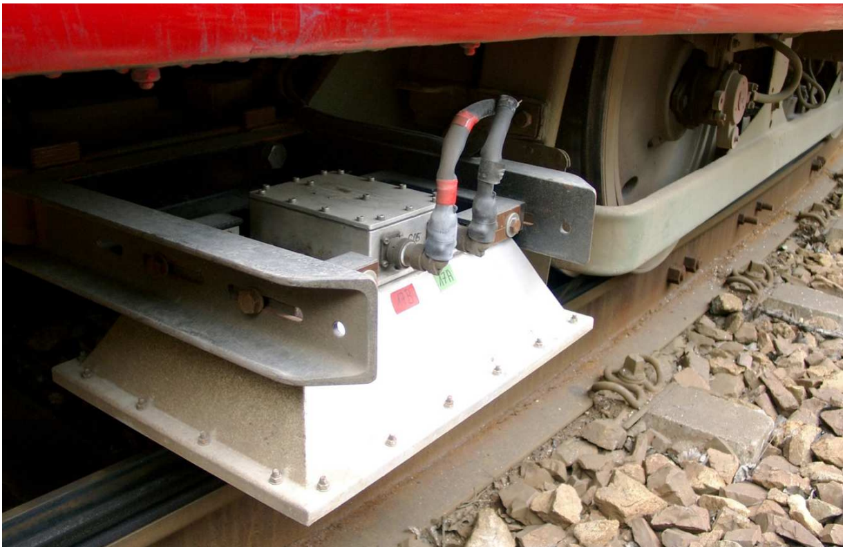
Abbildung 2.4: An einem Triebwagen der AVG angebrachter Laboraufbau mit zwei Wirbelstrom-Sensoren in einem Gehäuse.
