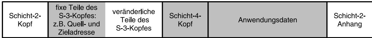
Abbildung 3.2: Die grau unterlegten Teile jeder Nachricht werden von der Quellsignatur abgedeckt.
