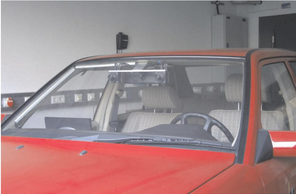
**Bild 6.1:** Das starre Stereokamerasystem im Versuchsfahrzeug des Instituts für Mess- und Regelungstechnik.
