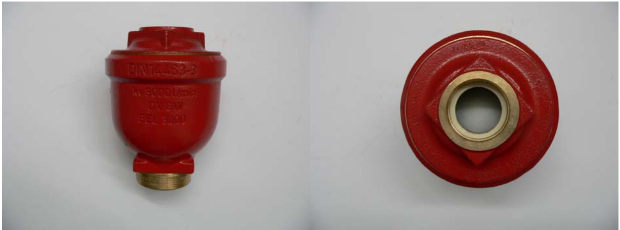
Bild A-6: Be- und Entlüftungsventil PN 16 (Abbildung: DN 50, Entlüftungsmenge bis 3000 l/min) nach DIN 14463-3 [15] .
