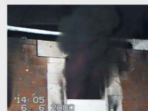
12 min 58 s (nach Zündung) an der Fensteröffnung Flashover
