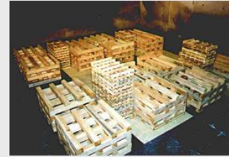
Brandlast: ca. 336 kg (Holzkrippen: ca. 314 kg, Linoleum: ca. 19 kg, Nadelfilzteppichboden: ca. 2 kg, Heptan: 1 l)
