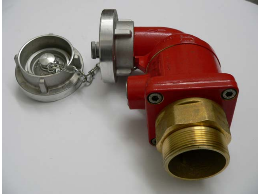
Bild A-5: Schlauchanschlussarmatur PN 16 für Steigleitung „trocken“ nach DIN 14461 Teil 5 [14] .
