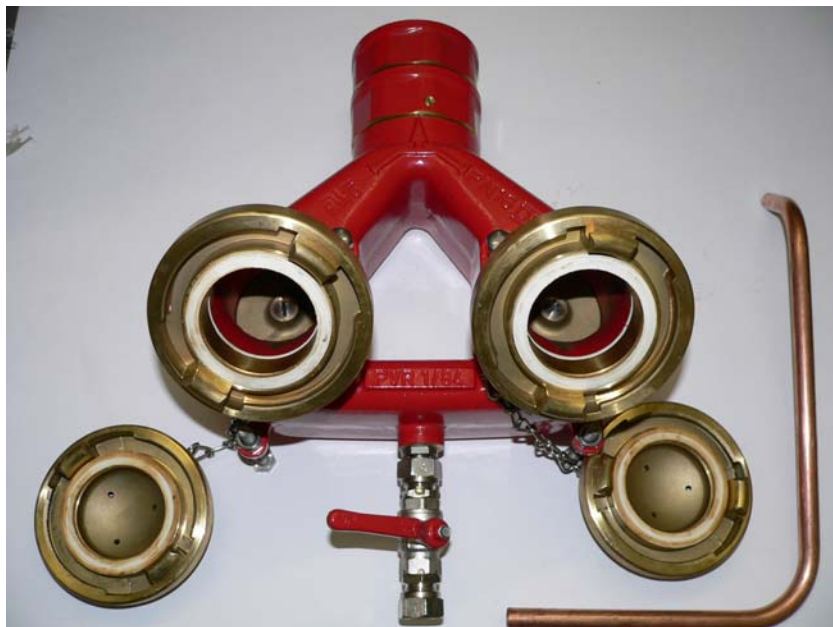
Bild A-3: Einspeisearmatur PN 16 für Steigleitung „trocken“ nach DIN 14461 Teil 4 [13].
