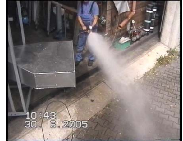
Einzeldüse – 135 bar Ablenkung durch Wind (3 m/s)
