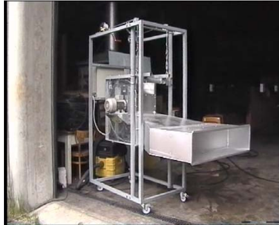
Radialgebläse zur Winderzeugung Windgeschwindigkeit: 3 m/s
