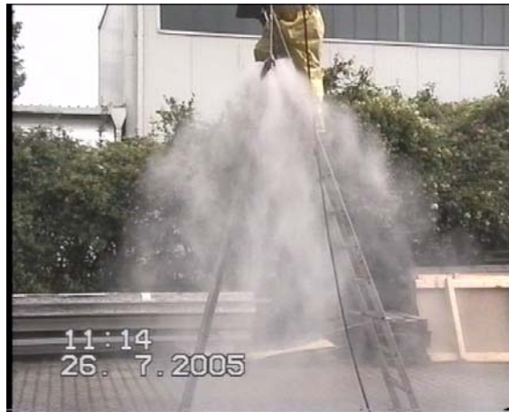
Sprühkopf mit 4 Düsen 135 bar
