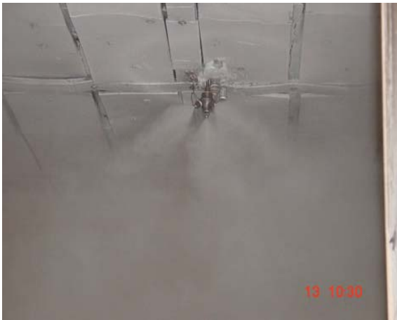
Sprühkopf mit 4 Düsen 135 bar
