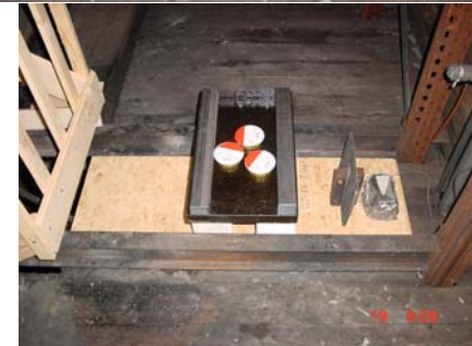
3.83 Bratpfanne mit auf Flammpunkttemperatur vorgeheiztem Pflanzenöl (Vorheizung mit Glasdeckel - hier entfernt; 1 l, 2 l Öl) auf 3 Pastenbrennern
