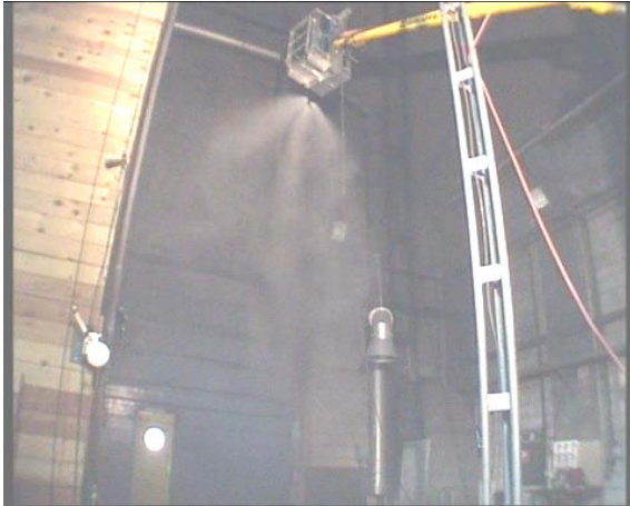
Sprühkopf mit 4 Düsen – 135 bar Höhe des Sprühkopfes: 5 m
