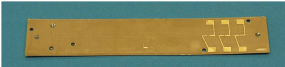
Abb. 4-8 CE-Chip aus PEEK mit drei CCD-Elektrodenpaaren
