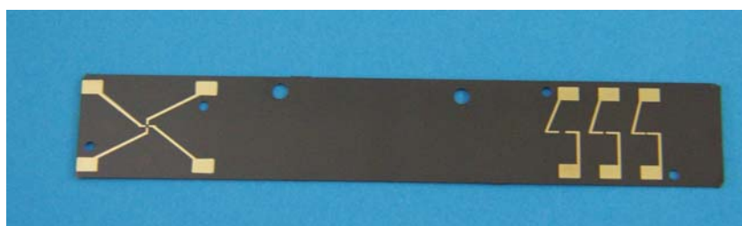
Abb. 3-13 Polyimid-CE-Chip mit aufgesputterten CCD-Elektroden
