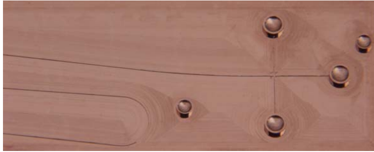
Abb. 3-3 Formeinsatz aus CuBeCo im Injektionskreuzungsbereich
