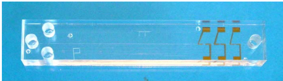
Abb. 3-12 CE-Chip aus PMMA mit Reservoirstruktur
