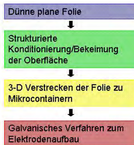
Abb. 4-4 Mehrstufiges Verfahren zur Beschichtung von verstreckten Folien.
