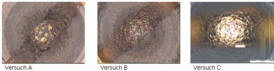
Abb. 4-8 Lichtmikroskopische Aufnahme mit unterschiedlichen Sputterparametern. Bei Versuch A (LINKS) waren sowohl die Sputterzeit als auch der Sputterstrom zu gering. Bei Versuch B (MITTE) war die Sputterzeit zu gering und bei Versuch C (RECHTS) waren Sputterzeit und Sputterstrom optimal.
