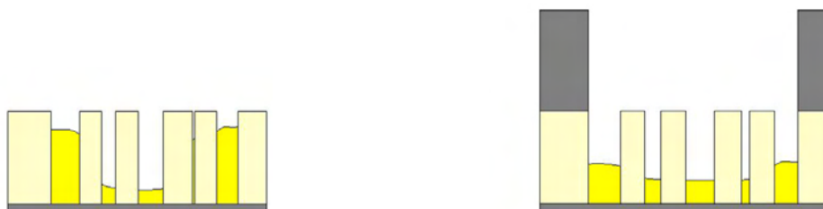
Abb. 3-20 Homogenisierung der Schichtdickenverteilung in Mikrostrukturen durch zusätzliche Blende (RECHTS): Abgeschlossene Goldabscheidung in Mikrostrukturen LINKS ohne montierte Blende und RECHTS mit Blende.
