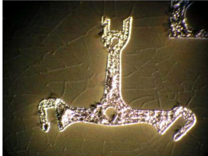
Abb. 5-13 Mikrogalvanisch abgeschiedene, stark rissige Gold-Palladiumlegierung (Sollhöhe 10 \mu\text{m} ).
