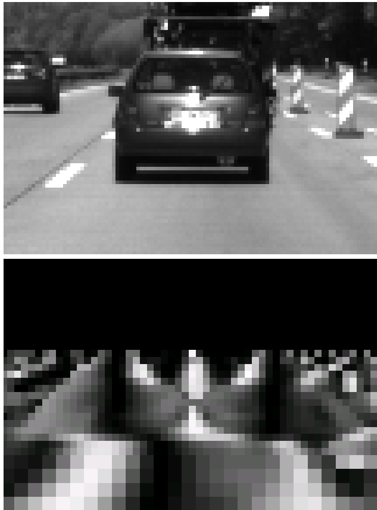
Bild 2.20: Oben: Vergrößerter Ausschnitt aus Bild (2.19), der ein zu detektierendes Fahrzeug zeigt. Unten: Entsprechender Ausschnitt der Symmetriekarte.
