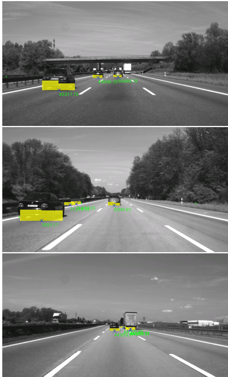
Bild 5.8: Detektionsbeispiele: Tracks sind durch zwei gelbe Balken gekennzeichnet, die die Modellwahrscheinlichkeiten, einem Balkendiagramm gleich, wiedergeben. Die Höhe des linken Balkens repräsentiert das Modell der konstanten Relativgeschwindigkeit, die des rechten Balkens das der konstanten Relativbeschleunigung. Im mittleren Bild sind an der Leitplanke zwei Fehldetektionen zu erkennen.
