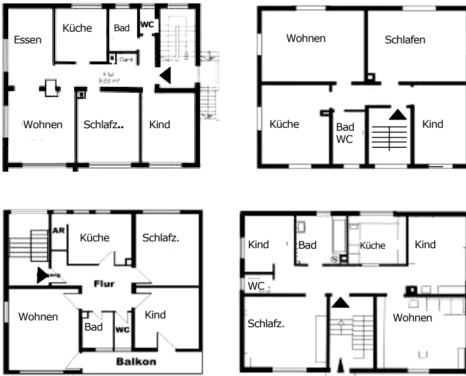
Abb. 44: Vier Grundrissbeispiele von Zweifamilienhäusern, EG/OG jeweils identisch, Überzeichnungen im Internet veröffentlichter Immobilienangebote mit einem Baujahr von 1956 bis 1972
