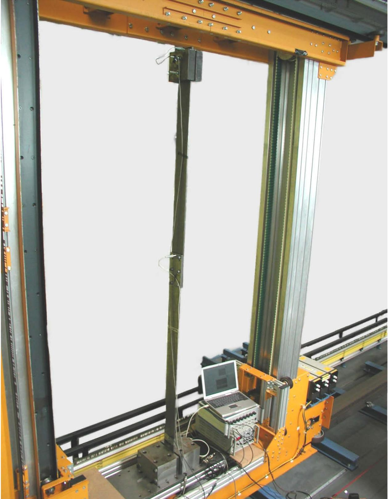
**Abb. 93:** Idealisiertes Hubgerüstmodell einfachster Geometrie
