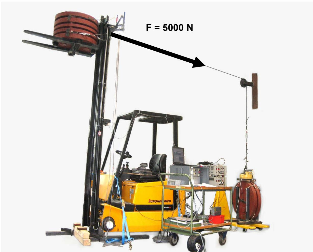
**Abb. 13:** Versuchseinrichtung realer Stapler
