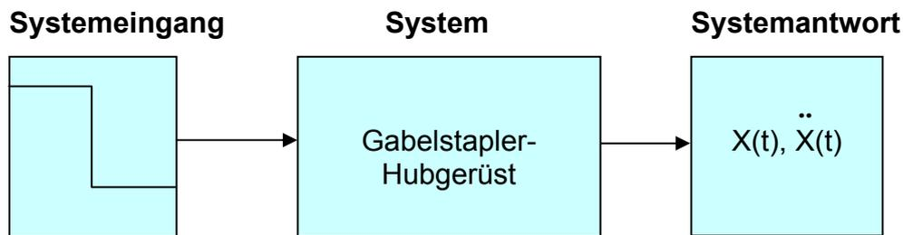
**Abb. 20:** Kraftsprung zur Anregung von Hubgerüst-Schwingungen
