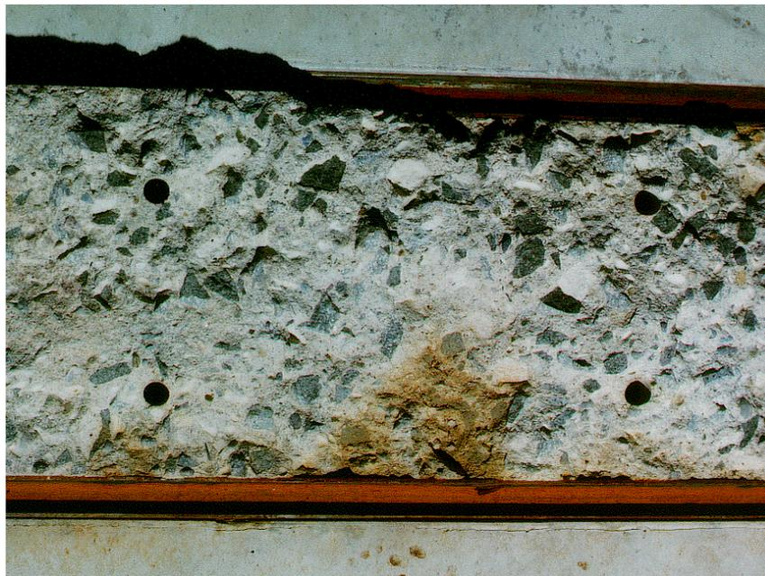
Abbildung 5.23: Foto der Bruchfläche eines Versuchskörpers zur Bestimmung der Leckage am Einzelriss [26]
