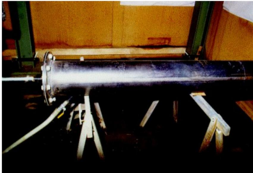
Abbildung 3.1: Leckageverhalten von ungerissenem Beton - Bild des Versuchskörpers [26]
