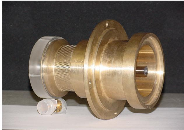
Abb. 6.8: Kavität für den  $TE_{34,19}$ -Modenerzeuger nach der Fertigung.
