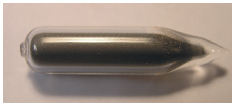
Abbildung 2.1: Abgeschmolzene NMR-Probe. Die Pulverproben wurden in Suprasilglas eingebracht, das Glasröhrchen wurde abgepumpt und durch den Glasbläser verschlossen. Die Röhrchen haben eine Gesamtlänge zwischen 2,2cm und 2,8cm und einen Durchmesser von 0,6cm. Die Einwaage beträgt zwischen 582mg und 748mg.
