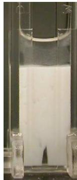
**Abbildung 11.21:** W/O 3. Am Küvettenboden ist die Ausbildung einer Wasserphase zu erkennen. Der Schleier in der Ölphase wurde durch nicht sofortiges Fotografieren nach dem Ende der Messung hervorgerufen.
