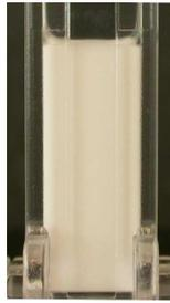
**Abbildung 11.1:** Zwickelflüssigkeit in den Küvettenecken bestätigt die stattgefundene Entmischung.
