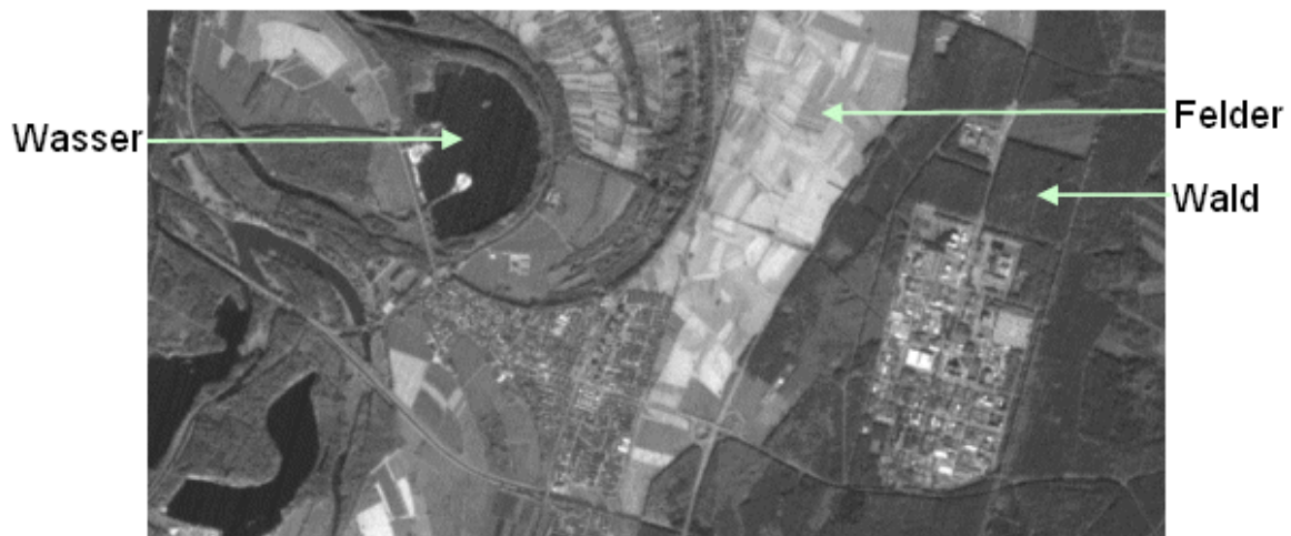
Abbildung B.5: Bildausschnitt eines IRS-1C-Bildes (©Euromap) von unbebautem und bebautem Gelände. Auf Grund der Textur kann im Bild z.B. auf die Objekttypen Wasser, Felder und Wald geschlossen werden.
