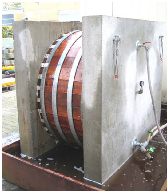
Bild 6-10 Versuch: optimierter Anschluss Holz - Beton
