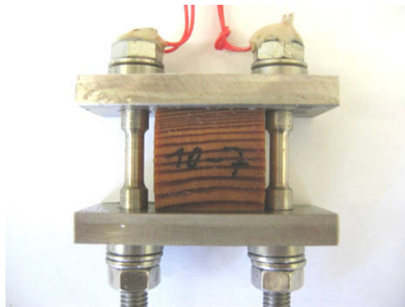
Bild 5-5 Versuchsaufbau zur Bestimmung des Quellungsdruckes bei behinderter Quellung
