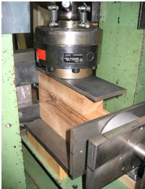
Bild 4-20 Versuchsaufbau zur Ermittlung der Haftungs- und Reibungskoeffizienten
