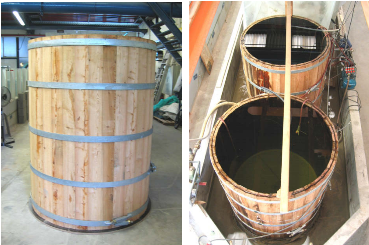
Bild 7-1 stehende Rohrabschnitte zur Untersuchung des Quellverhaltens von Druckrohrleitungen aus Holz
