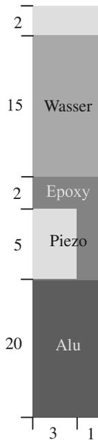
**Abbildung 4.16** Elementarzelle im Längsschnitt
