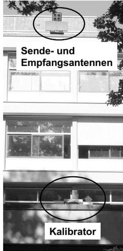
Bild 7.22: Messaufbau auf dem Dach mit Kalibrator und Sende- und Empfangsantenne auf dem Dach
