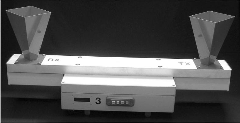
Bild 5.32: Komplettsystem Transponder mit Antennen und Kabelschutz für die Hochfrequenzleitungen
