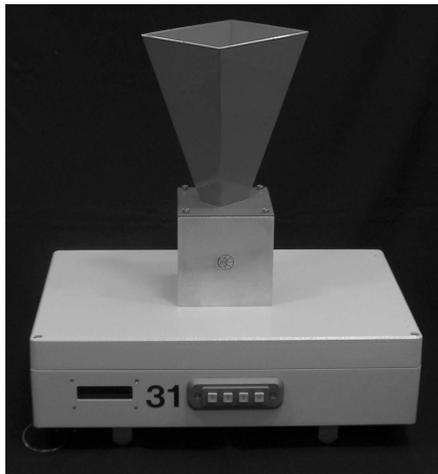
Bild 5.33: Komplettsystem Bodenempfänger mit Antenne
