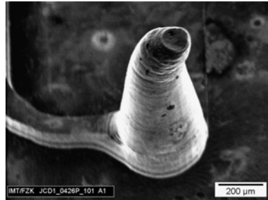
(b) Durch Prägekräfte verformter Düsenstift.
