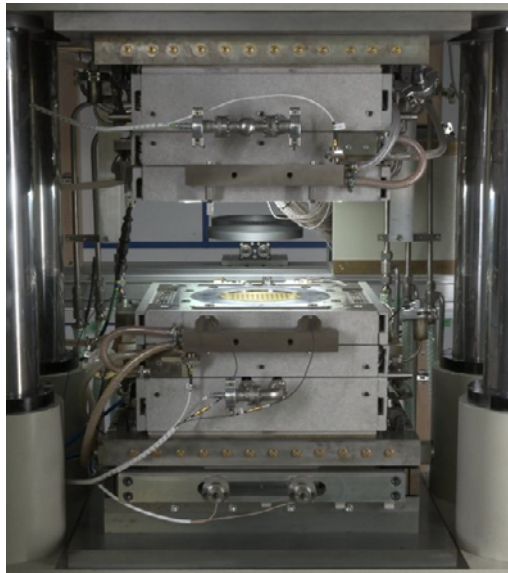
Abbildung 2.13: Gesamtansicht des Präzisionswerkzeugs für die beidseitige Strukturierung aufgebaut auf der WMP1000.
