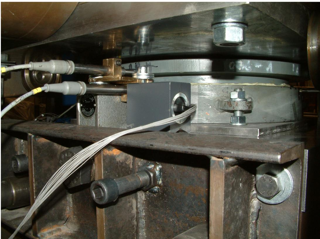
Abbildung 5.7: Ermittlung der Ringaufweitung und Deckelrelativverschiebung mittels induktiver Wegaufnehmer
