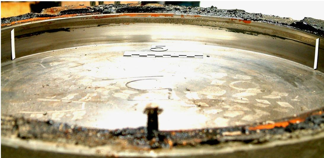
(a) Übersicht der Kontaktschäden entlang der Topfwand
