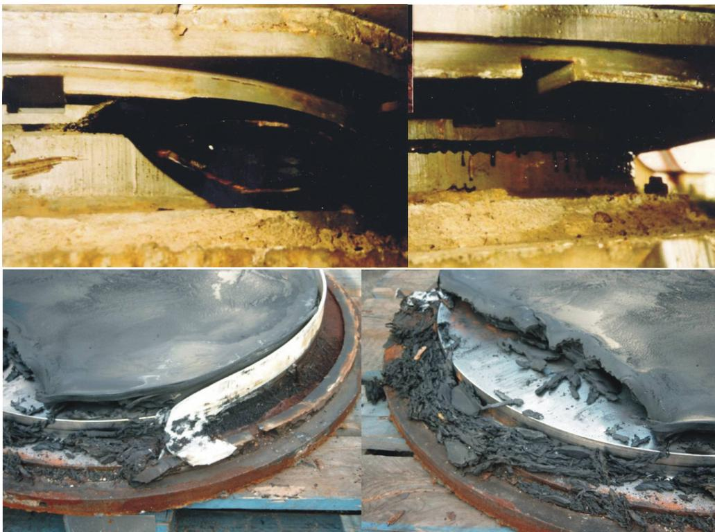
Abbildung 2.7: Austritt von Elastomer aus dem Kippspalt und geschädigte Elastomerkissen und Innendichtungen nach dem Ausbau [55]
