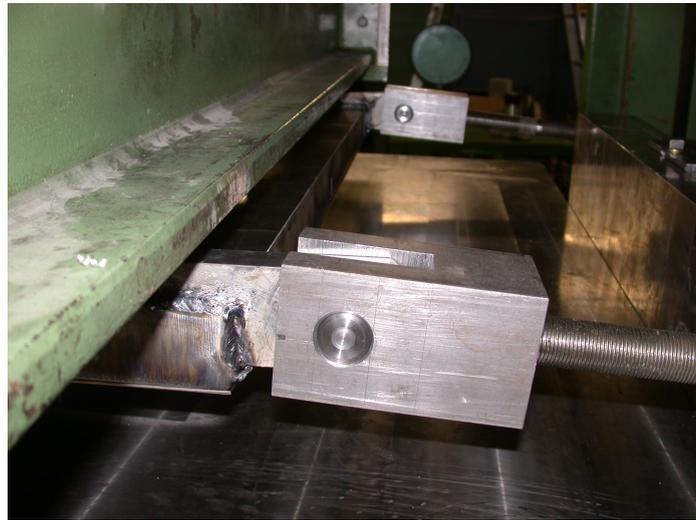
(b) Spannstangenanschluss an der Gleitplatte
