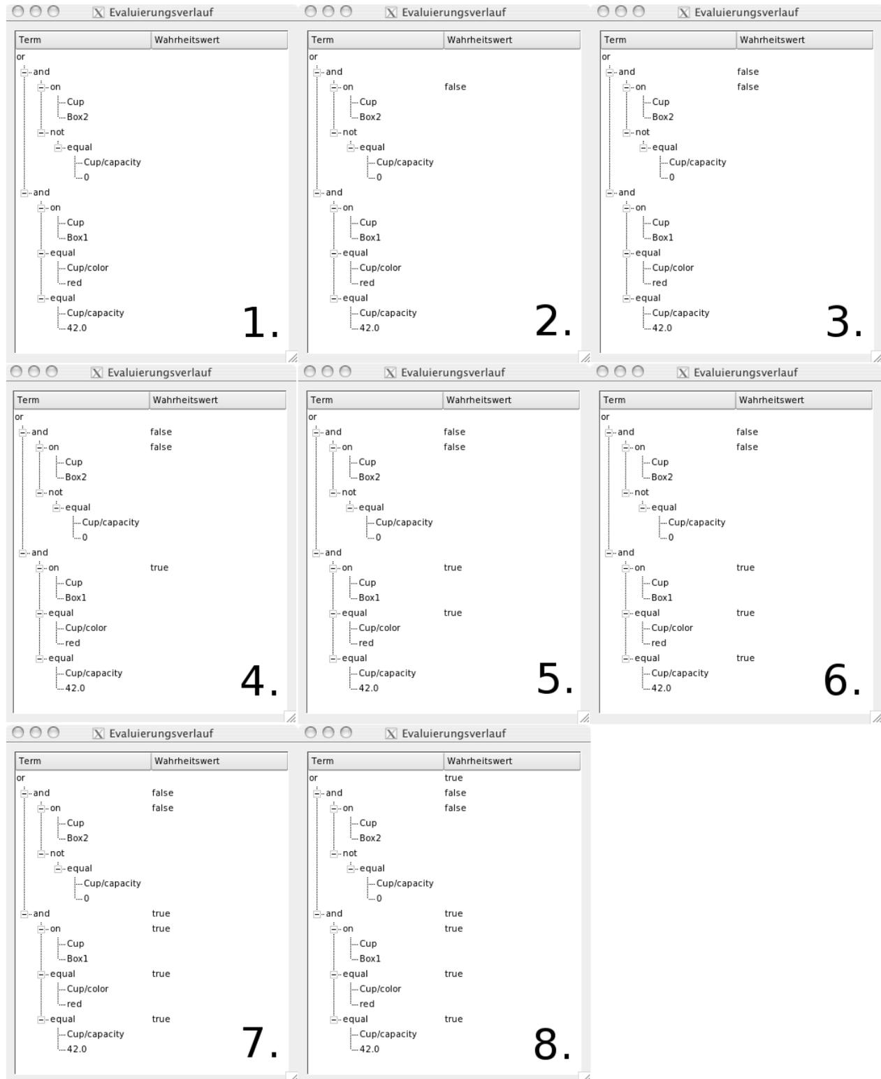
Abbildung 8.6: Verlauf der Evaluierung der Bedingung aus Programm 8.1. Zu erkennen ist, dass vorzeitig bekannte Terme nicht bis zum Ende ausgewertet werden (Schritt 2 und 3). Der gesamte Ausdruck wird letztendlich in Schritt 8 mit WAHR bewertet. Die einzelnen Atome werden im lokalen und globalen Weltmodell überprüft.
