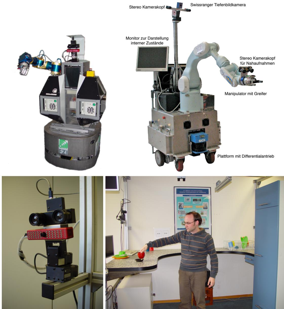
Abbildung 8.14: Einsatzszenarien für die Bewegungsverfolgung und Aktivitätserkennung. Oben die Roboter ALBERT II (IAIM) und *Jido* (LAAS/CNRS), darunter der Sensoraufbau der Sensorik für Experimente sowie für die Posenverfolgung im Trainingscenter.
