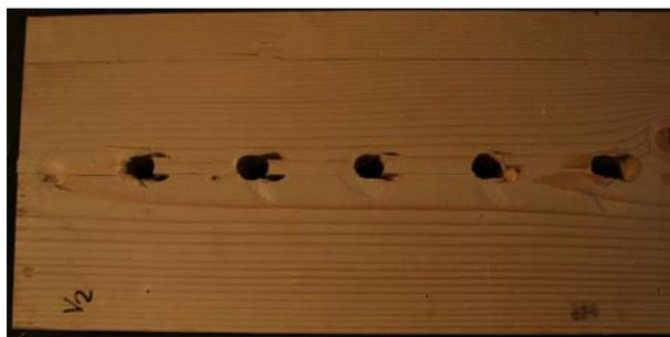
Bild 9: Blockscheren in den Decklagen
