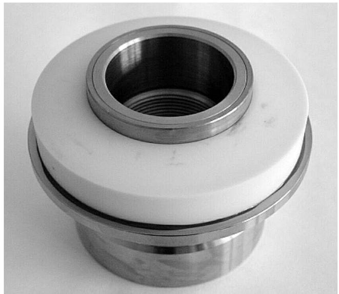
Abbildung 6.20: Festscheibenhalter Variante "Klebung" mit  $\text{Al}_2\text{O}_3$  Kegelscheibe
