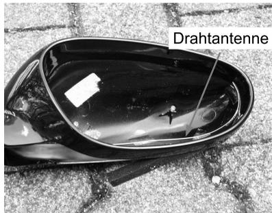
Abbildung 4.12: Versilberter Kupferdraht als Antenne im Kunststoffspiegelgehäuse eines Außenspiegels für den Porsche Boxster S durch Klebestreifen fixiert.
