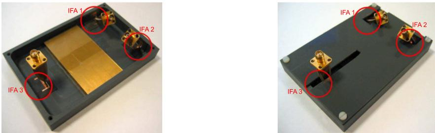
Abbildung 6.13: Drei Inverted-F Antennen mit offenem und geschlossenem Gehäuse inklusive Batterieblock.
