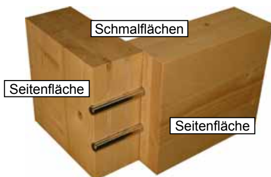
Abb. 1 Geöffnete Stabdübelverbindung in Seiten- und Schmalflächen von Brettsperrholz
