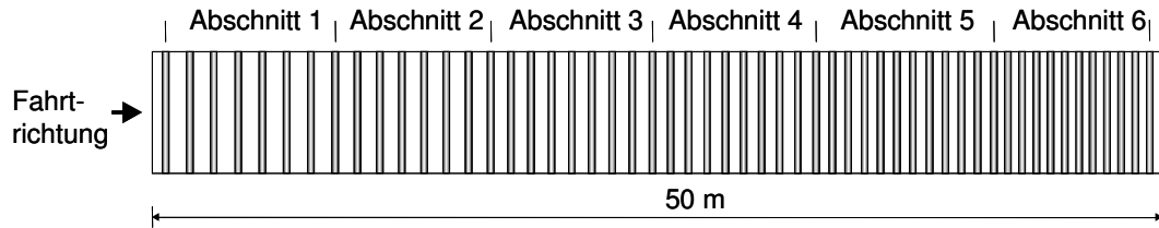
Abbildung 4.4: Anordnung der Schwellen und Abschnitte der Waschbrettstrecke
