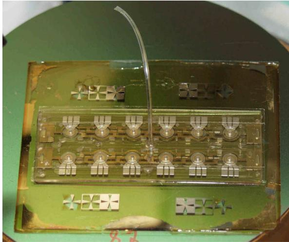
Bild 7.5-4: Klebstoff wird zentral in die miteinander verbundenen Klebstoffkammern gespritzt.
