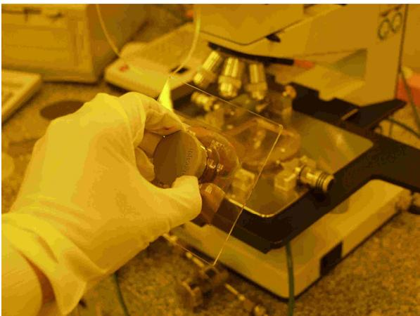
Bild 7.4-2: Ausgerichtete Chrommaske mit Glassubstrat zwischen Vakuumplatte und Magnet
