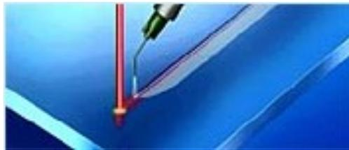
Bild 2.4-8: Volltrenn-Laserschneiden von Dünngläsern [Scho05].
