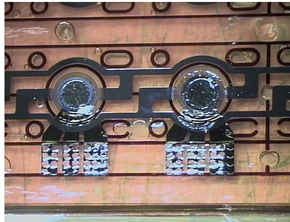
Bild 2.10-10: Gehäusenutzen nach der Reinigung in Wasser mit Zitronensäure.
