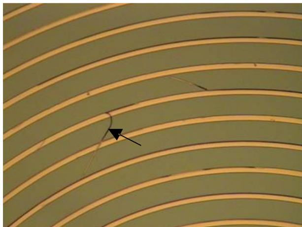
Bild 2.7-11: Filmränder sind als schwarze Linien an 5 µm breiten DMS-Leiterbahnen aus Gold auf einem Siliziumwafer erkennbar. Der Pfeil zeigt auf einen abgelösten Filmrand. Der Wafer wurde mit einer MED 010 besputtert.
