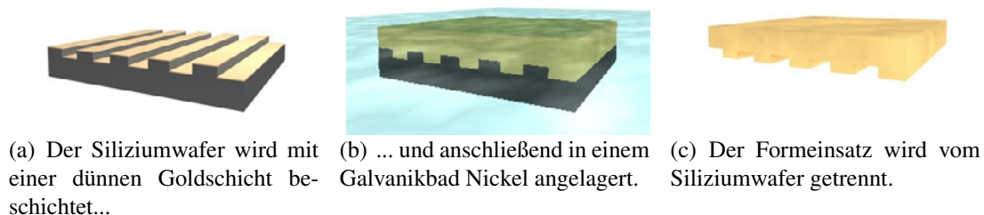
Abbildung 7.11: Schema der Herstellung eines Nickelformeinsatzes im LIGA-Verfahren
