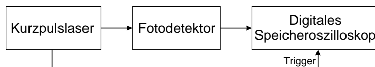
Abbildung 5.14: Schema des Impulsantwortmesssystems
