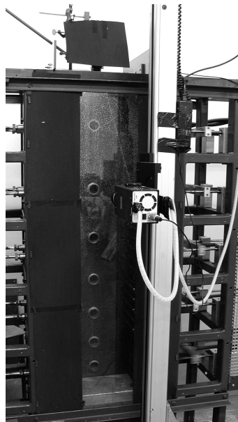
Abbildung 3.5. Differentielle Turbulenzsäule mit Laser-Lichtschnitt und PIV-Kamera
