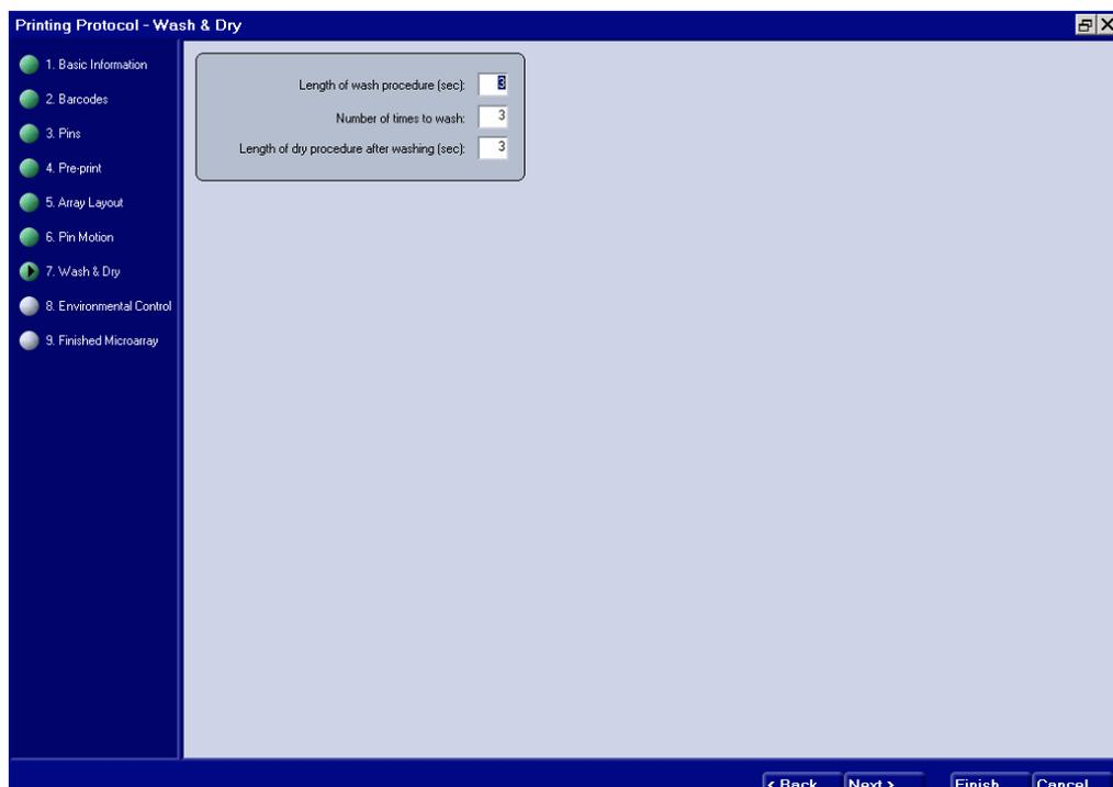
Einstellung von Nadelwaschzyklen und -Washzeit, sowie der Trocknungsdauer nach jedem Waschgang.
